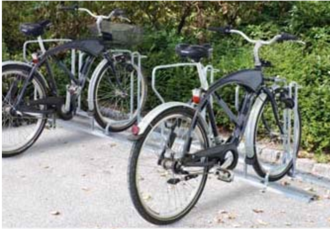
Fahrradparker TACOMA, 4 Stellplätze, einseitig 90°, Radeinstellung tief / tief, mit Bodenrahmen zum Aufdübeln bei +/- 0 mm, feuerverzinkt
